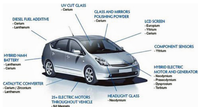
3. ábra. Ritka földfémek alkalmazása a Toyota Prius személygépkocsiban (üvegezés, katalizátor, szenzortechnika, akkumulátor, elektromos motorok és generátorok)
