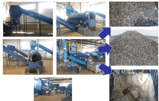
7. ábra. A fehérvárcsurgói szeparációs prototípus és az általa leválasztott anyagfrakciók
