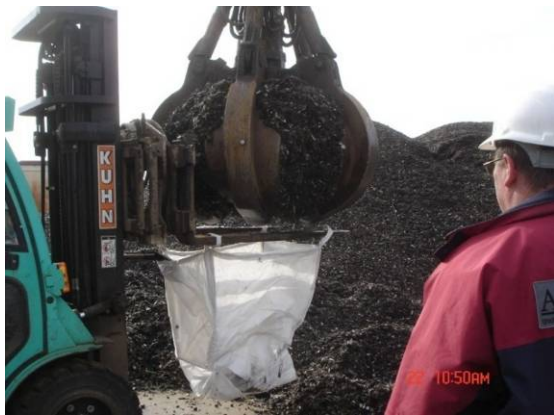
6. ábra. Shredder-könnyűfrakció mintavételezése Fehérvárcsurgón
