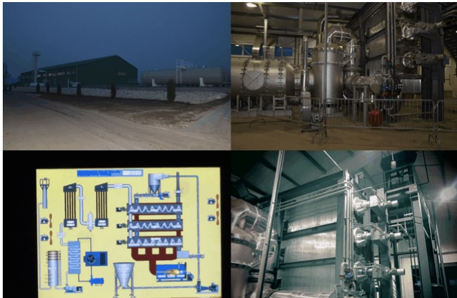
8. ábra. Termokatalitikus hőbontó prototípus Fehérvárcsurgón
